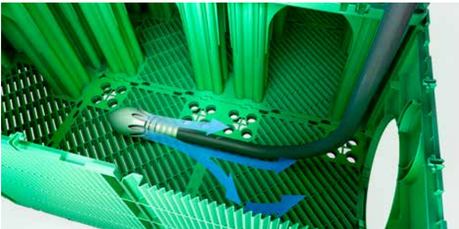
Inovativní konstrukce bočních stěn a dna - šikmé žebrování během čištění odráží proud vody a zabraňuje poškození geotextilií
