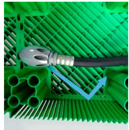
Inovativní konstrukce bočních stěn a dna - šikmé žebrování během čištění odráží proud vody a zabraňuje poškození geotextilií
