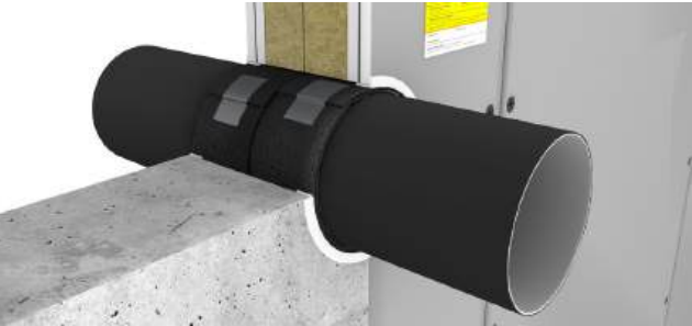
Protipožární manžety nebo rukávce musí být nasazeny na obou stranách části potrubí Master3Plus, které vede skrz stěnu požárního úseku.
