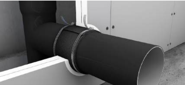
Odpovídající počet vrstev (dle specifikace Hensotherm) požárního obalu Hensotherm 7KS o tloušťce 100 mm musí být aplikován kolem odpadních a kanalizačních potrubí Master3Plus, která procházejí šachtovými stěnami opláštěnými z jedné strany.
