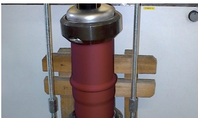
Zkouška těsnosti 2,5 baru
