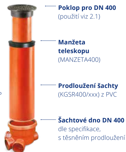
Příklad sestavy šachty DN 400 s hladkým prodloužením
