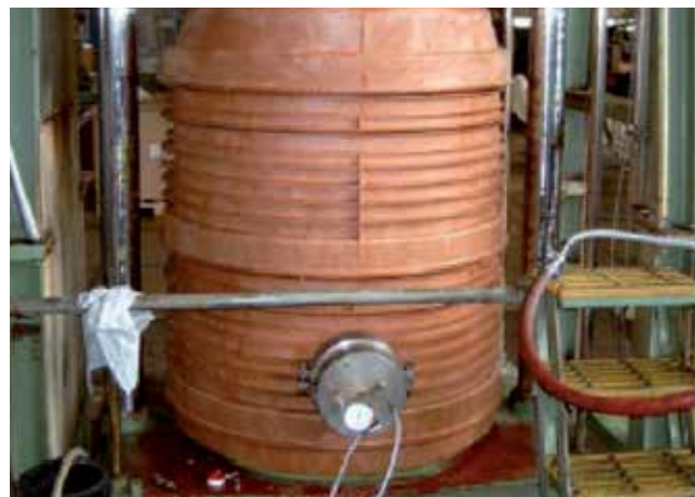
Přetlaková zkouška sestavy
