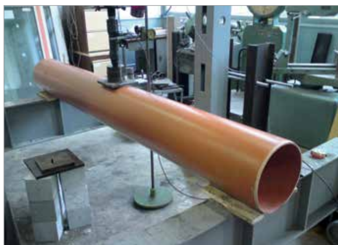
Laboratorní zkouška průhybu
