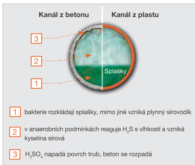
Porovnání chemické koroze
