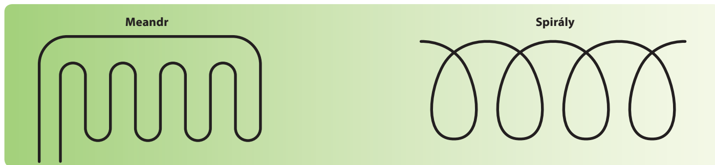
obr. 4 - způsob pokládky PE trubek
