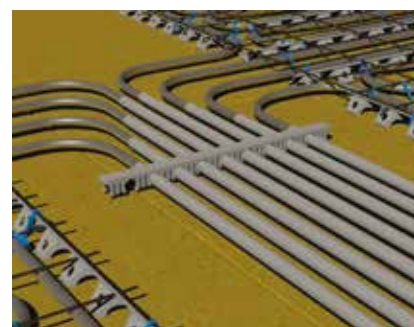
28. Pokládka spojovacích trubek
