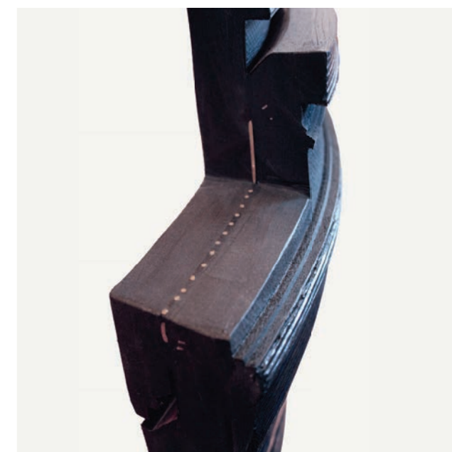
Detail spoje po elektrofúzním svařování
