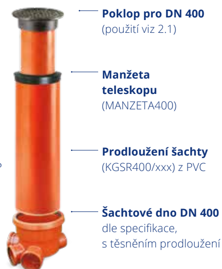
Příklad sestavy šachty DN 400 s hladkým prodloužením
