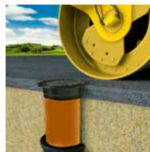
Instalace teleskopu Obr. 21
