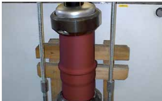
Obr. 2 - Zkouška těsnosti 2,5 baru
