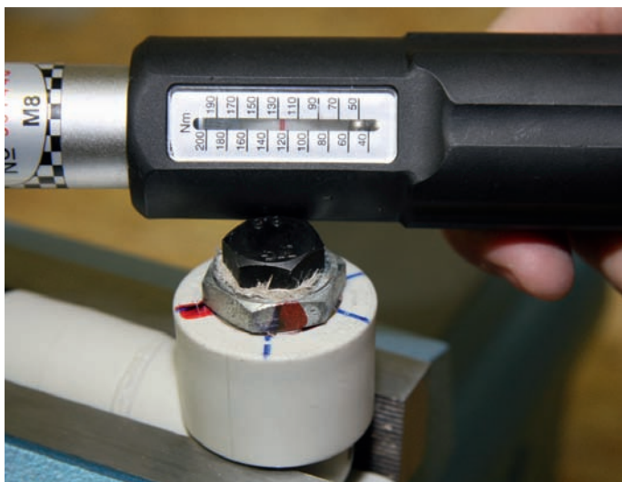
Obr. 2. Výrazné protočení u konkurenční tvarovky při 125 Nm
